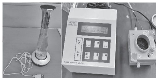
図 2. 微酸性次亜塩素酸水作製装置 (左) とクロラインメーターによる有効塩素濃度の測定 (右)
