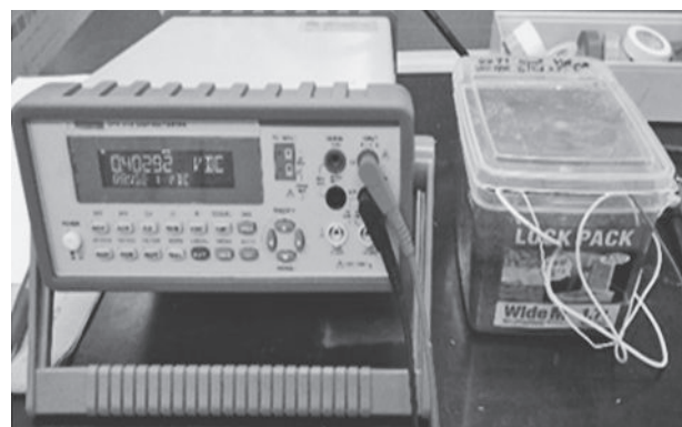
図 1. 作製したルーメン内容物微生物燃料電池 (右, ルーメン MFCs) とデジタルマルチメーター (左) による電圧の測定
